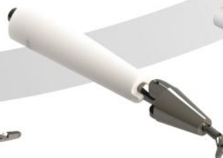
SONDA ARTICULADA COM MÃO EM FORMATO CONE 3,5 A 4,5 ANOS UL 60335-2-24
