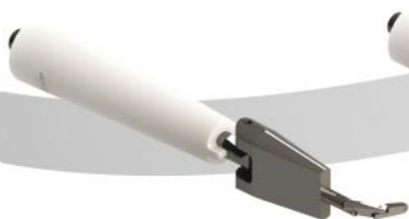
SONDA ARTICULADA COM MÃO EM FORMATO PLANO 3,5 A 4,5 ANOS UL 60335-2-24
