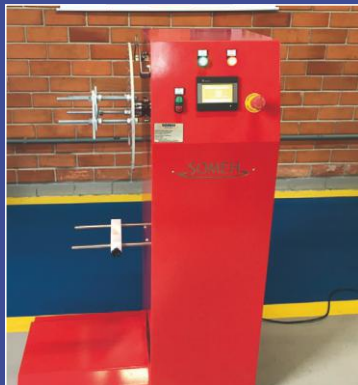
ENSAIO DE FLEXÃO EM CABOS IEC 60745-1
