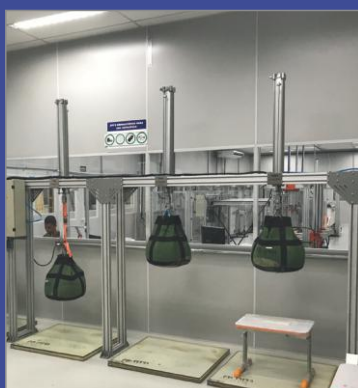
ENSAIO DE CARREGAMENTO ESTÁTICO EM CADEIRAS PLÁSTICAS - NBR 14776 ITEM 4.2.1
