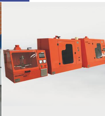
LABORATÓRIO DE ENSAIOS EM ELETRODOMÉSTICOS CONFORME IEC 60335-1
