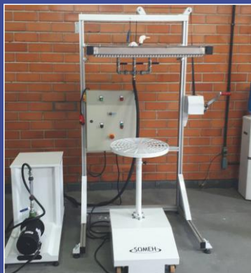
CAIXA GOTEJADOR IPX1 E IPX2 IEC 60529 ÍTEM 14.2.1 E 14.2.2
