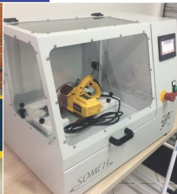
ENSAIO DE ABERTURA DA PROTEÇÃO DE SERRA CIRCULAR - IEC 60335-2-5
