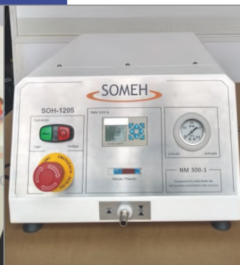
ENSAIO DE BRINQUEDOS ACIONADOS PELA BOCA PORTARIA 263 ÍTEM 5.3.11
