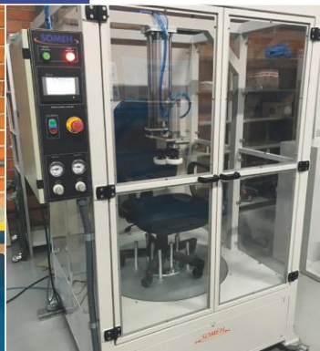
ENSAIO DE ROTAÇÃO NBR 13962 ITEM 7.3.6
