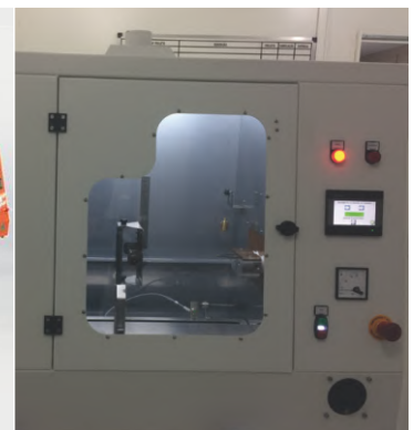
ENSAIO DE FIO INCANDESCENTE IEC 60695-2-10
