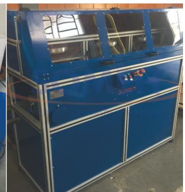
ENSAIO DE FADIGA EM ESPUMAS FLEXÍVEIS - NBR 9177
